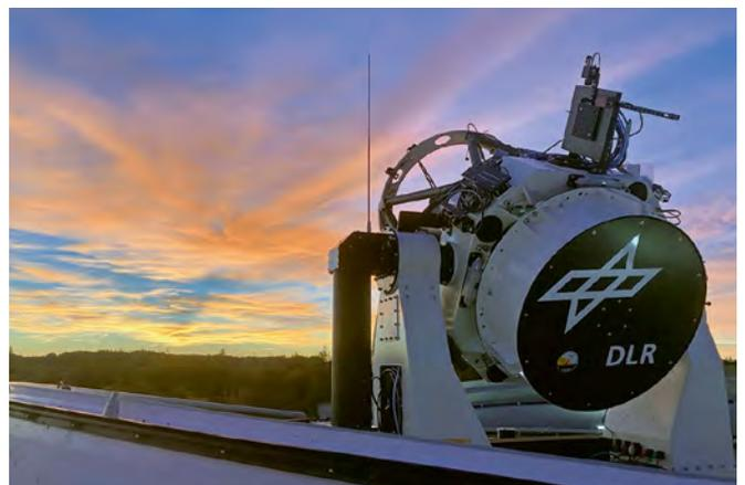
So soll der QUBE-Kleinstsatellit Daten per optischer Verbindung zur Bodenstation übertragen, um Experimente zur Quantenschlüsselverteilung zu ermöglichen.
