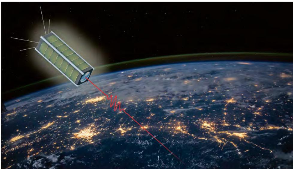
So soll der QUBE-Kleinstsatellit Quantenschlüssel mit einem Laser zur Bodenstation übertragen, um anschließend damit abhörsichere Kommunikation auf der Erde zu ermöglichen.
