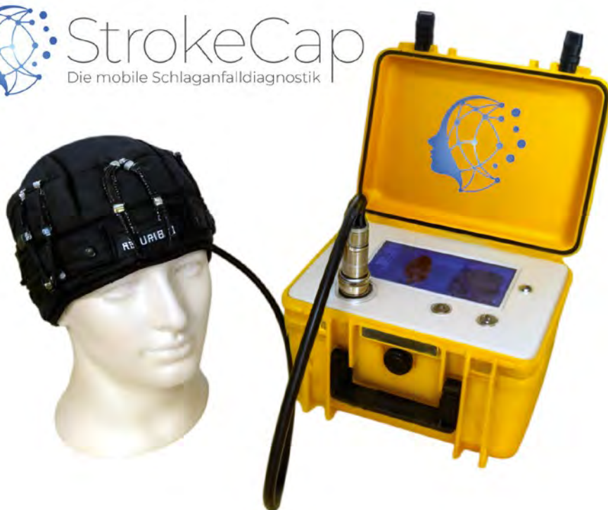
Demonstrator der StrokeCap und Ansteuerelektronik.
