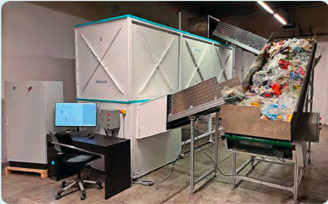
Im Technikum in der Posthalle Würzburg trainiert die Künstliche Intelligenz des Start-ups WeSort.AI ihre Fähigkeit zur Müllerkennung und -sortierung.
