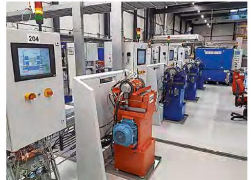
SKF errichtet derzeit ein Technologiezentrum im niederländischen Houten. Hier werden die SKF-Experten die Mechanismen hinter den unterschiedlichen Lager-Ausfällen auf den BRAVE-Testständen experimentell untersuchen.
