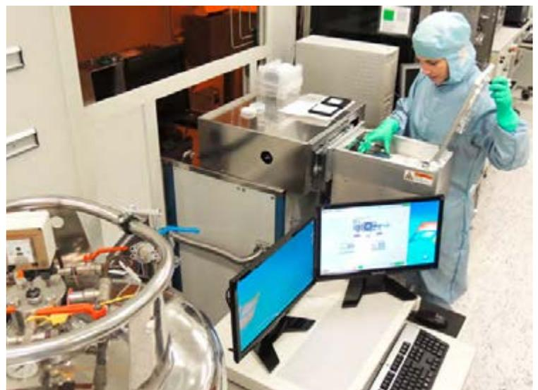
Mitarbeiterin der nanoplus Nanosystems and Technologies GmbH bei der Arbeit an einer Laserätzanlage. Bild: nanoplus
