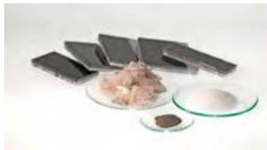
Das neuartige Zerkleinerungsverfahren, beispielsweise anwendbar auf Solarzellen, verbessert die Ausbeute und die Qualität der zurückgewonnenen Materialien.
