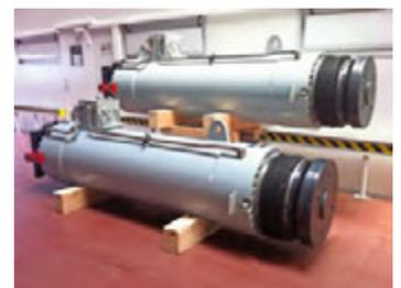
O+P-„Hub- und Nivellierzylinder“ – für Nasa-Raketentransporter.
