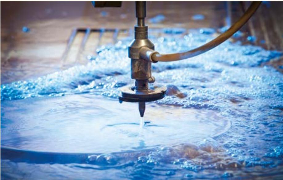
Wasser mit einem Druck von bis ca. 4000 bar komprimiert und mittels einer Düse zu einem Strahl mit 0,1 – 1mm Durchmesser gebündelt wird. Der Schneidstrahl wird auf eine Geschwindigkeit von ca. 900m/s beschleunigt, das entspricht etwa der dreifachen Schallgeschwindigkeit.
