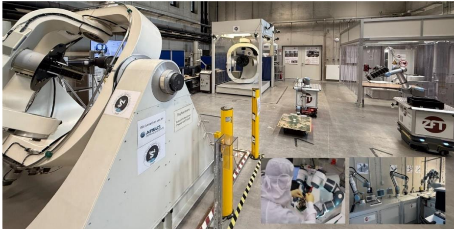
Bild 4: Blick in die „Forschungsfabrik Kleinsatelliten“ mit Dynamik-Testgeräten, Rütteltisch und mobilen Robotern zur möglichst realistischen Simulation der Weltraumumgebung im Labor.
