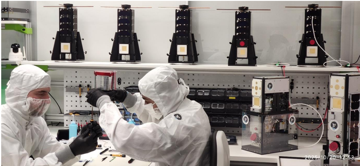
Bild 1: Der Reinraum in Würzburg füllt sich mit kompletten Satelliten: Auf dem Board links die 3 TOM-Satelliten, rechts 2 CloudCT-Vorbereiter. Auf dem Tisch stehen 2 fertige CuBy, während der 3 gerade integriert und getestet wird. (Quelle: Prachit Kamble, S 4 GmbH, Würzburg)
